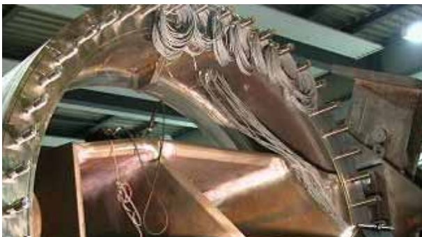
Dehungs- und Kraftmessung an einer Ventilklappe vor Ort
