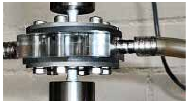
Dynamische Prüfung in der Korrosionskammer
