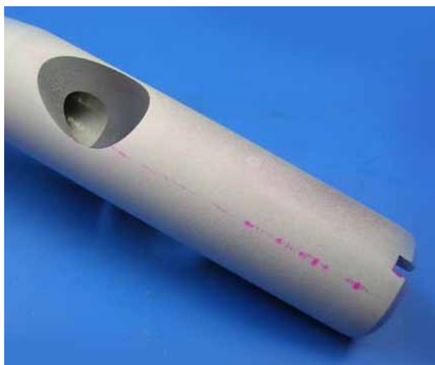
PT-Prüfung an fehlerhaftem Teil
