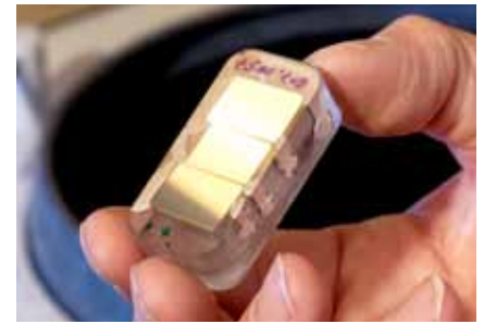
Schliffprobe (vorbereitet für die REM-Analyse)
