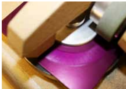
Taber Test an beschichteter Platte
