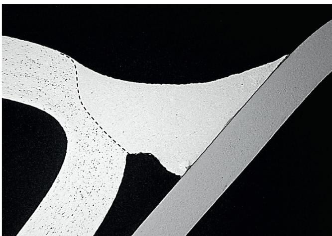
Abb. 3: Einbrand im Aluminiumblech; Stahlblech nicht angeschmolzen; Anbinde-längelänge zwischen Schweißgut und Stahlblech > 3 mm; Festigkeitswerte liegen auf dem Niveau von Aluminium-Schweißverbindungen; Versagen in der Regel aluminiumseitig d.h. im Schweißgut oder in der WEZ
