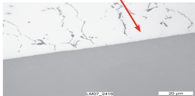
Abb. 15 & 16 Verbindung Aluminium/Titan
